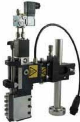
**En vez de emplear el sistema de rodillo, se instala una cabeza de aplicación superficial. Con el cabezal de aplicación, se pueden alcanzar bordes de hasta 60 mm de altura. Hemos ajustado la altura de la aplicación manualmente con un tornillo de ajuste.**
